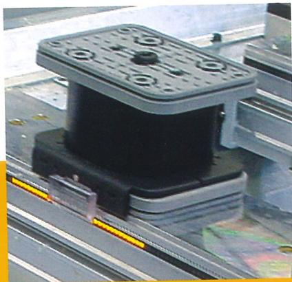
Vakuumsauger mit speziellem Kammersystem (Patent der Homag Gruppe) zur freien Positionierung auf den Konsolen. Leuchtdiodenketten (LED) zur einfachen und schnellen Positionierung der Vakuumspanner und Konsolen (Option).
