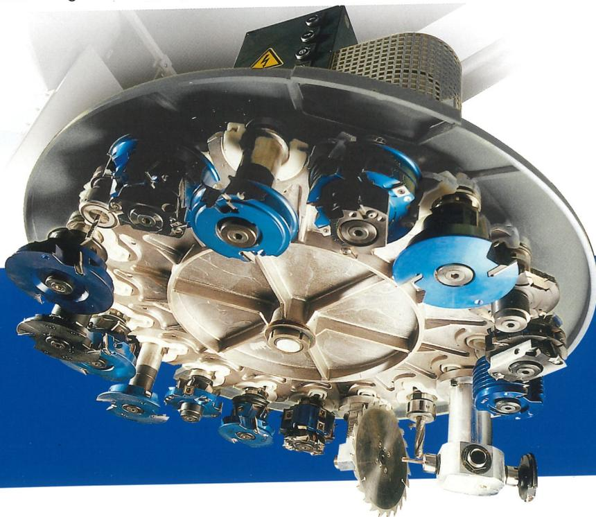
Bohrkopf mit 12 Vertikalspindeln (Optional 17 Vertikalspindeln) und einem bzw. zwei Freiplätzen für optionale Zusatzaggregate wie Nutsäge oder Nebenspindel. Ideal für die schnelle Komplettbearbeitung ohne Werkzeugwechsel bis zu einer Arbeitstiefe von 1625 mm.
