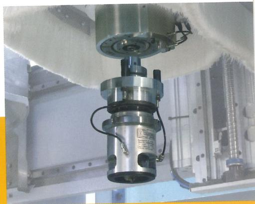
Die Pneumatikschnittstelle der C-Achse ermöglicht das Durchleiten von Druckluft z.B. für eine Abblasvorrichtung. Damit kann das getastete Fräsaggregat eingesetzt werden, ohne dass Späne die Qualität beeinflussen. Die Dreipunkt-Abstützung der C-Achse sorgt für hohe Steifigkeit beim Dauereinsatz schwerer Aggregate z.B. bei der Treppenfertigung.
