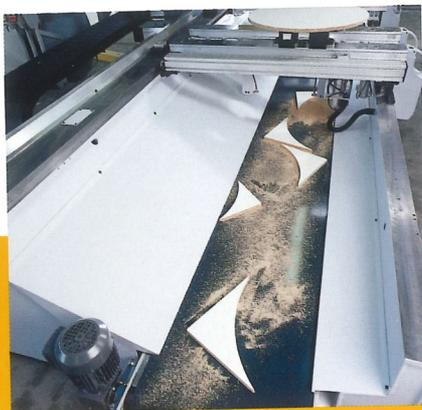
Arbeitsfeld von X = 4.175 mm und Y = 1.300 mm (optional 1.625 mm mit Nebenspindel) mit Reststückentsorgung über das glatte Maschinenbett (optional mit Späntransportband).
