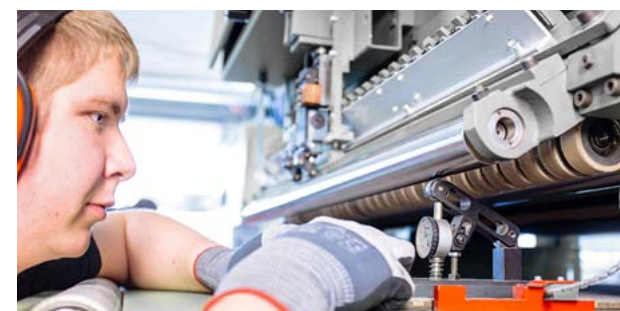
Der Servicetechniker kalibriert das Messsystem einer Gebrauchsmaschine.
