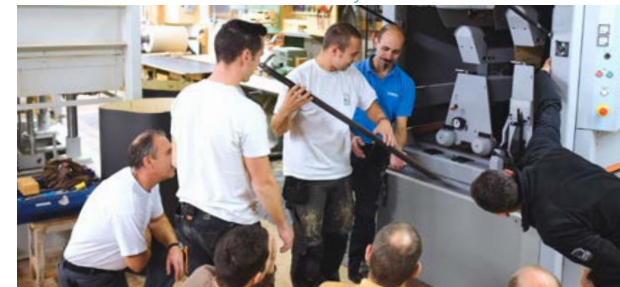
Schulung an der neuen Kündig: Demonstration des Graphit-Gleitbelages.
