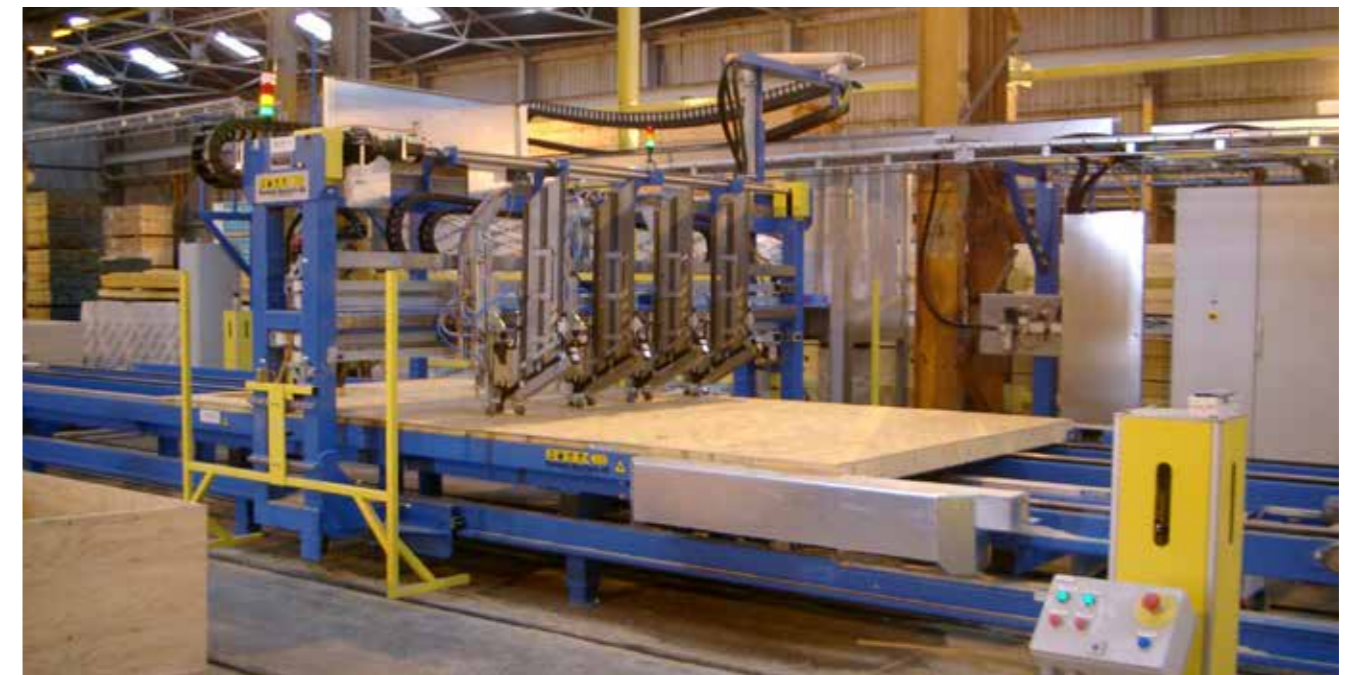
Eine CAD/CAM gesteuerte automatische Nagelbrücke (NB3000) oder eine manuelle Nagelbrücke (NB1000F) können eingesetzt werden.
