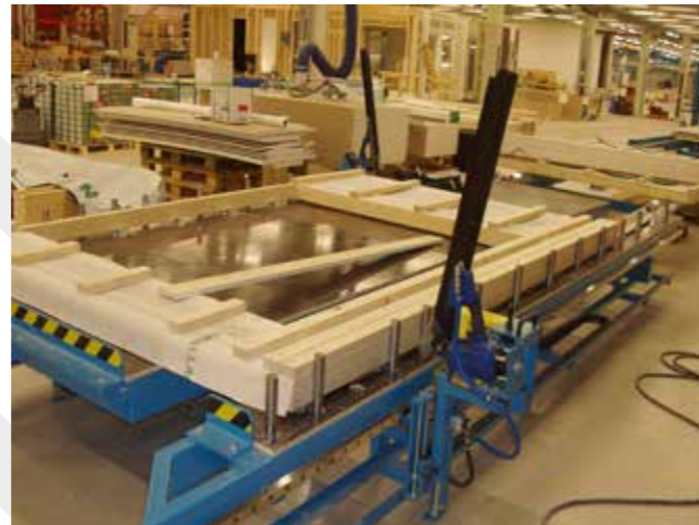
Nagelwagen mit Gewichtsausgleich an einem Legetisch FT2000
