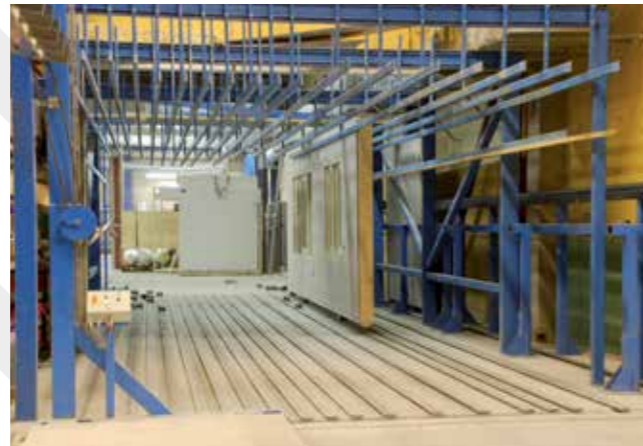
Wegklappbare Bolzen ermöglichen das Weiterfördern der aufgerichteten Wand vom Einfach-System direkt in ein Lagersystem.
