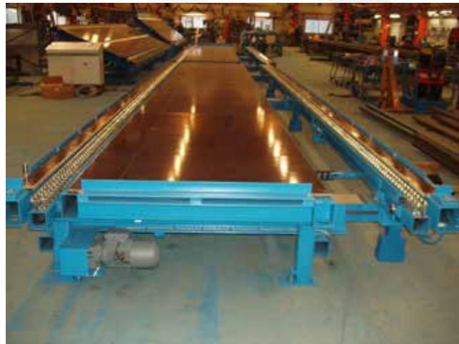
Legetisch FT1000, ausgerüstet mit Röllchenbahnen
