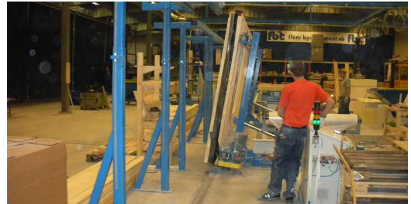
Das Wandelement ist aufgerichtet und wird durch ein Transportsystem aus dem Combi System - SF004 vertikal zum effektiven Einbau von Fenstern etc. hinausgefördert.
