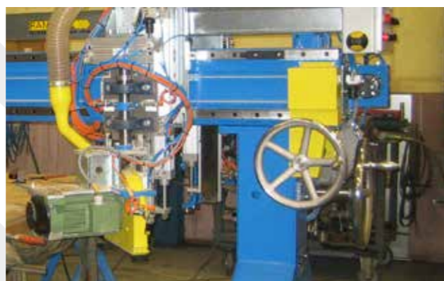
Możliwość montażu mostu zbijającego manualnego NB1000, pokazanego wyżej, lub mostu zbijającego ze sterowaniem komputerowym CAD/CAM NB3000.
