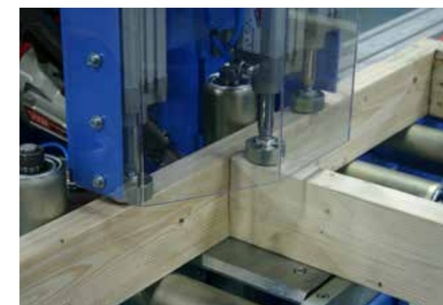
Widok z bliska systemu mocującego zainstalowanego na stacji FM1000 – wysoką jakość i wydajność produkcji drewnianych szkieletów.
