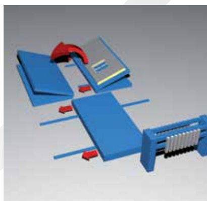
Stół do zbijania szkieletów wyposażony jest w wózki goździarkowe z przeciwwagą przemieszczane wzdłuż stacji, które zapewniają bezpieczne i precyzyjne zbijanie drewnianego szkieletu.
