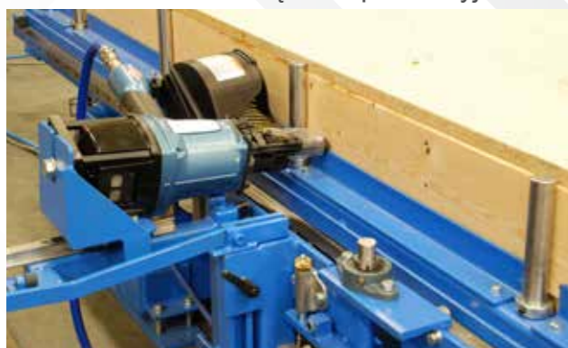
Stół do zbijania szkieletów wyposażony jest w wózki goździarkowe z przeciwwagą przemieszczane wzdłuż stacji, które zapewniają bezpieczne i precyzyjne zbijanie drewnianego szkieletu.
