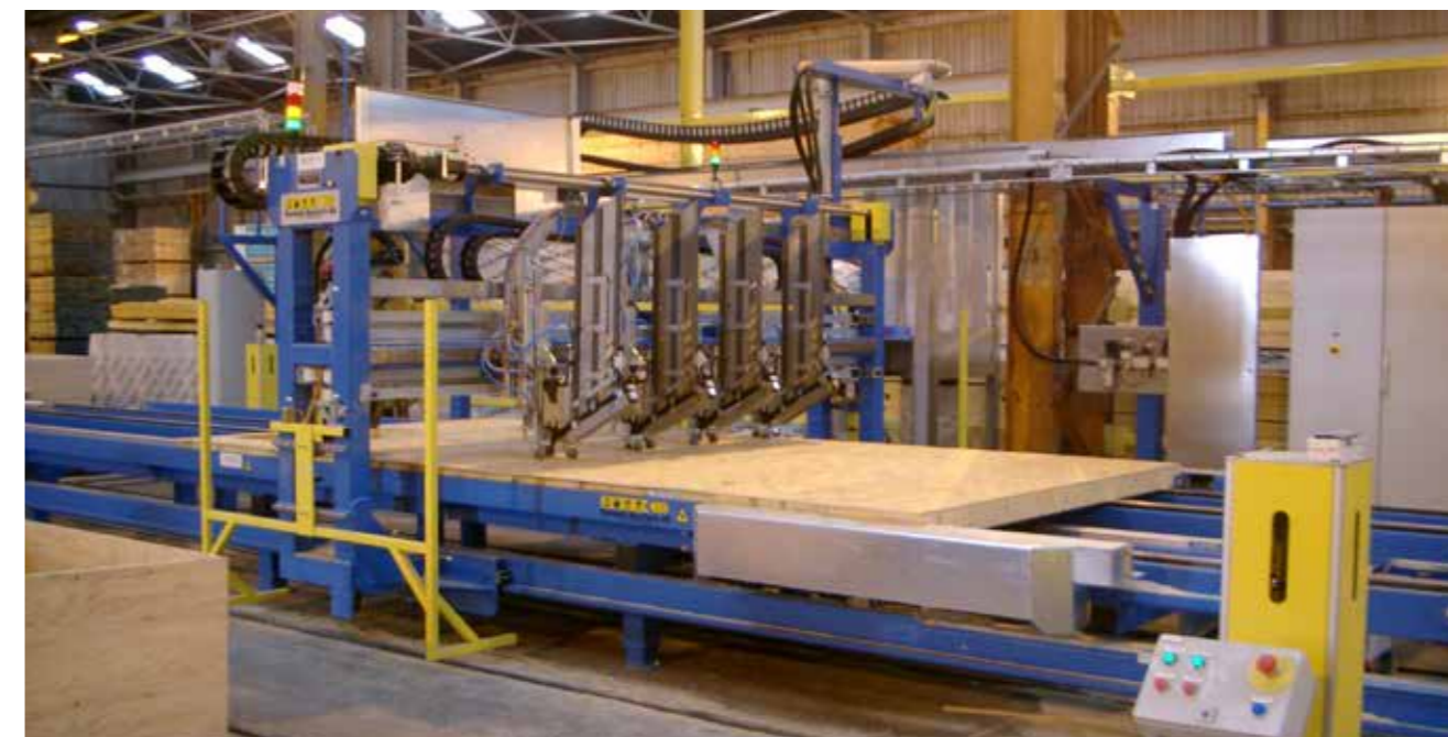
Możliwość stosowania mostu zbijającego ze sterowaniem CAD/CAM lub sterowaniem manualny NB1000F
