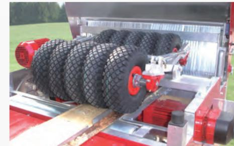
— Luftgefüllte Gummiräder garantieren hohe Haftung auch auf schwierigen Brettern, die vereist oder mit Sägemehl behaftet sind. Durch das bewegliche Gummiprofil fällt verklebtes Sägemehl automatisch ab. Im Vergleich zu Stahlwalzen deutliche Gewichtsreduzierung.
