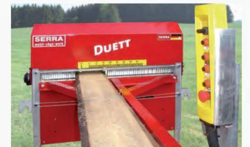
— Die Einstellung der Brettbreite erfolgt über eine angetriebene Spindel. Die Distanz der Kreissägeblätter wird auf einer Skala angezeigt. Auf Wunsch mit digitaler Anzeige erhältlich.
