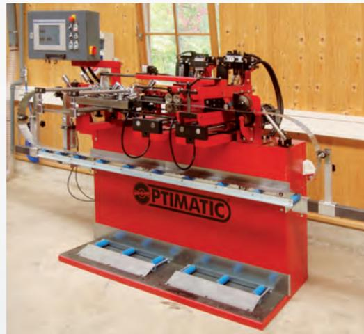
Bei uns werden alle Sägeblätter auf einer automatischen Walzbank der Firma Oppliger bearbeitet. Der Schweizer Hersteller gilt als der Erfinder dieses Maschinentyps. Die eigens für uns entwickelte Steuerung arbeitet besonders präzise und schnell. Qualitätsschwankungen wie beim sonst üblichen manuellen Walzen, werden dadurch ausgeschlossen. Jedes Sägeblatt wird einer strengen Qualitätskontrolle unterzogen.
