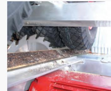
— Rückschlagleisten mit integriertem Splitterschutz (hinten im Bild), mehrere Endschalter und entsprechende Abdeckungen machen das Arbeiten extrem sicher.
