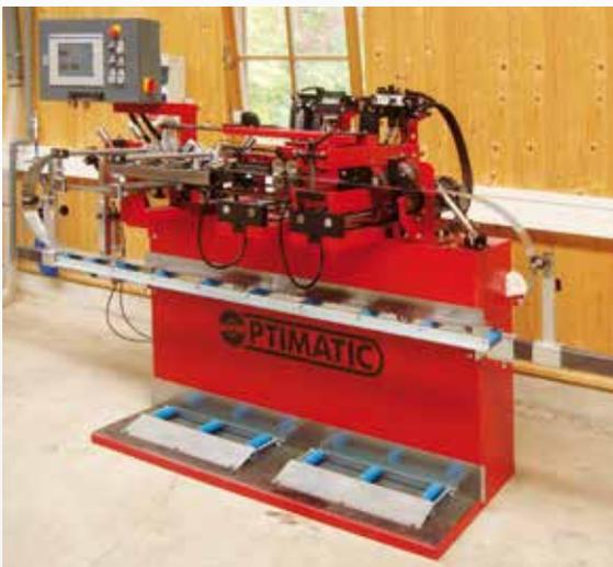
Bei uns werden alle Sägeblätter auf einer automatischen Walzbank der Firma Oppliger bearbeitet. Der Schweizer Hersteller gilt als der Erfinder dieses Maschinentyps.
