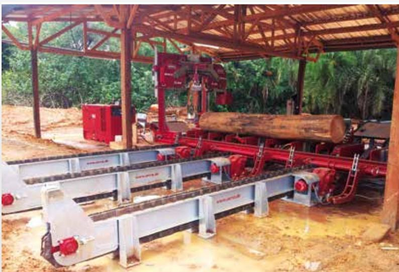
Bei Bestellung einer Sägewerksanlage für Stämme bis 1,6 m Durchmesser in Gabun, wurde uns die Aufgabe gestellt zwei Rundholzförderanlagen, die bis zu 30 Tonnen Gewicht je Anlage fördern können, zu entwickeln und zu liefern. Die Stämme werden vom Lader auf den Rundholzförderer abgelegt und können vom Bediener per Knopfdruck an die Stammheber der AFRICA heran gefördert werden. Von da werden sie direkt auf die Maschine gehoben.
