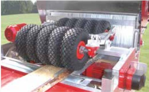
— Luftgefüllte Gummiräder garantieren hohe Haftung auch auf schwierigen Brettern, die vereist oder mit Sägemehl behaftet sind. Durch das bewegliche Gummiprofil fällt verklebtes Sägemehl automatisch ab. Im Vergleich zu Stahlwalzen deutliche Gewichtsreduzierung.
