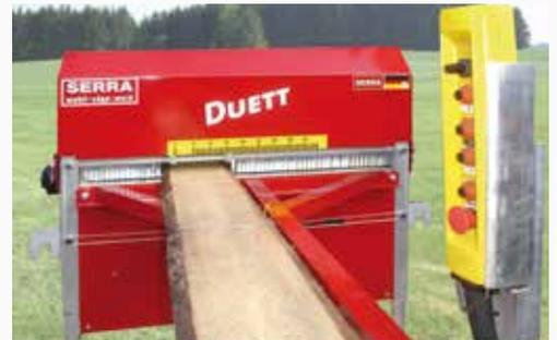
— Die Einstellung der Brettbreite erfolgt über eine angetriebene Spindel. Die Distanz der Kreissägeblätter wird auf einer Skala angezeigt. Auf Wunsch mit digitaler Anzeige oder Positioniersteuerung erhältlich.
