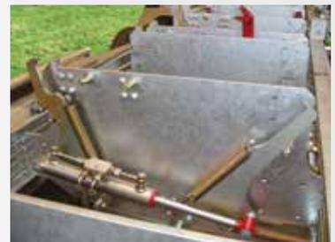
— **Präzision beim Schneidwerk** Schwere Stahlgussrollen mit 700 mm Durchmesser garantieren Laufruhe. Schräger Sägeschnitt. Nach oben versetzte hydraulische Mittelblattspannung bietet über dem Sägeblatt satte 42 cm Platz für das Schnittgut. Oberster Sägeschnitt 87 cm über dem Sägebett. Automatische Sägeblattschmierung. Sägeblattführung serienmäßig hydraulisch zustellbar. Ein Amperemeter zeigt die Stromaufnahme des Sägemotors an (Elektroversion).
