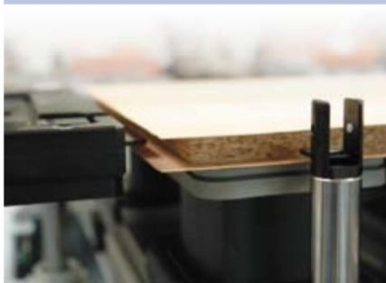
Gewährleistet einfaches Positionieren bei Material mit Furnierüberstand
