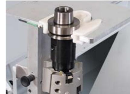
Sicheres und schnelles Beschicken des Werkzeugwechsellmagazines
