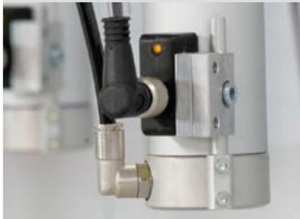
Erhöhte Sicherheit durch eine elektronische Endlagenabfrage an allen vorhandenen Anschlagzylindern
