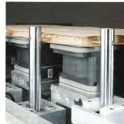
Pneumatischer Anschlag für Deckschichtüberstand
