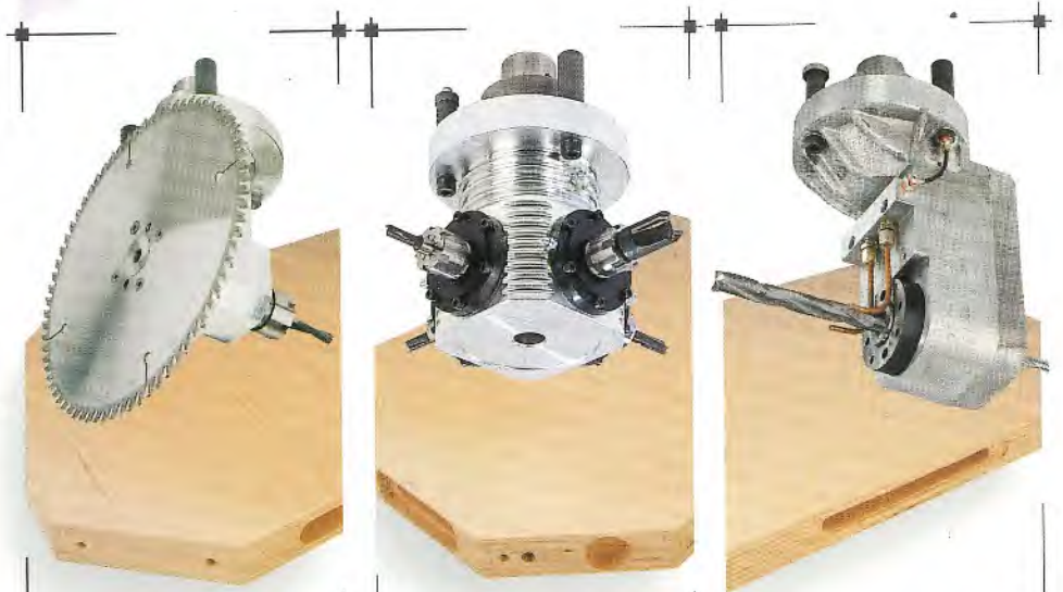
HSK 63 Schloßkastenaggregat 2 Spindler Für Schloßkastenfräsungen, Stulpfräsungen und horizontale Fräsungen bis zu einer Tiefe von 128 mm. Eine Abblasdüse räumt den erhöhten Spänefall aus – erhöhte Standzeiten des Werkzeugs (0°-360°).
