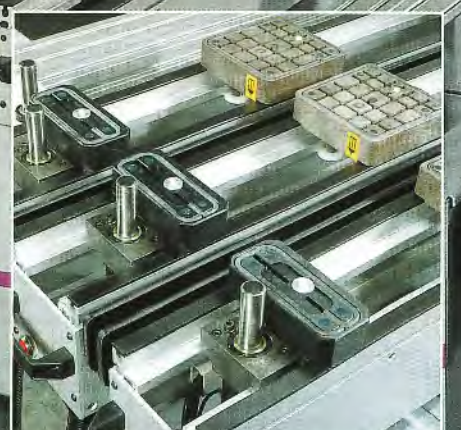
Standard: 2. Anschlagreihe (vorne) sowie 8 Vakuumschmalsauger
