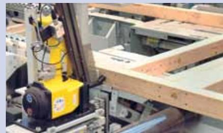
en place dans ce processus. L'élément considéré est transporté par la griffe d'évacuation à commande numérique vers les diverses positions des montants. Les plans de clouage à définir librement pour divers types de montants, L, U, T et montants multiples sont également une innovation.
