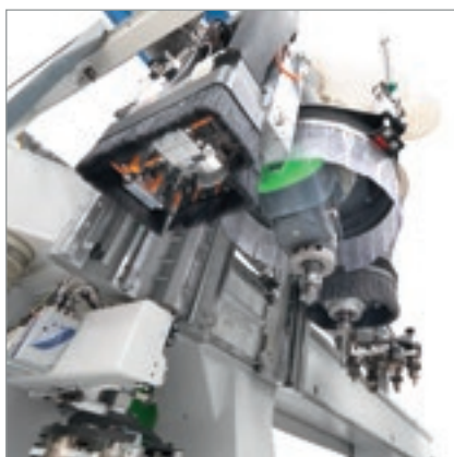
Unità di fresatura verticale da 6 kW.
