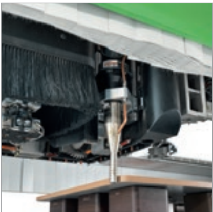
Gruppo soffiante ad aria fredda o calda per ravvivare il colore del bordo.
