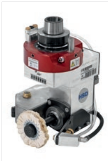
Agregado cepillador con pulverizador de líquido limpiador del hilo de cola.
