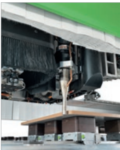
Grupo soplador de aire frío o caliente para reavivar el color del canto.
