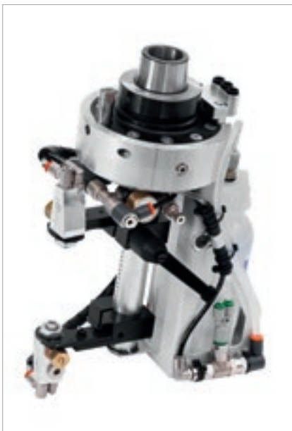
Продувочный агрегат и подача антиадгезионной жидкости.
