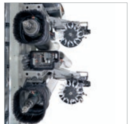
Schnelle Bestückung durch die am Wagen der Elektroschindel angebrachten Revolverwerkzeugmagazine.
