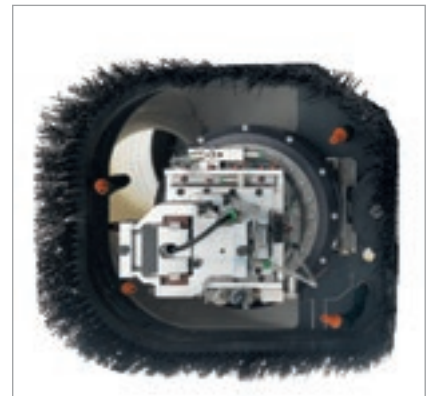
Ablaseinheit mit 4 Ausgängen, auch mit den Aggregaten für die Feinarbeitung der Kante verwendbar.
