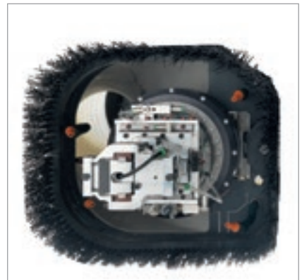
Gruppo soffiatore a 4 uscite utilizzabile anche con gli aggregati di finitura del bordo.
