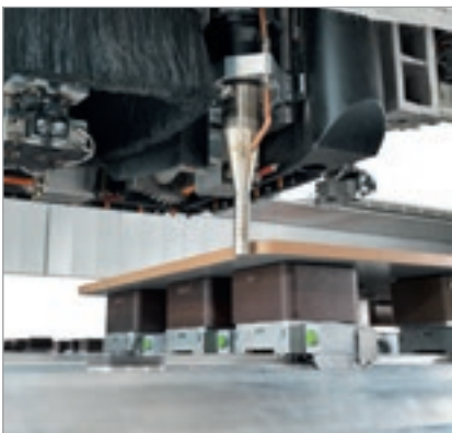
Gruppo soffiatore ad aria fredda o calda per ravvivare il colore del bordo.
