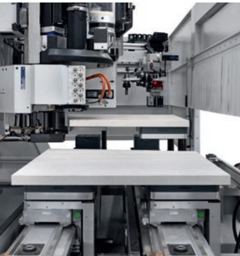
Sistemas de bloqueio pneumático Uniclamp e Hyperclamp de desengate rápido para bloqueios rígidos e precisos.
