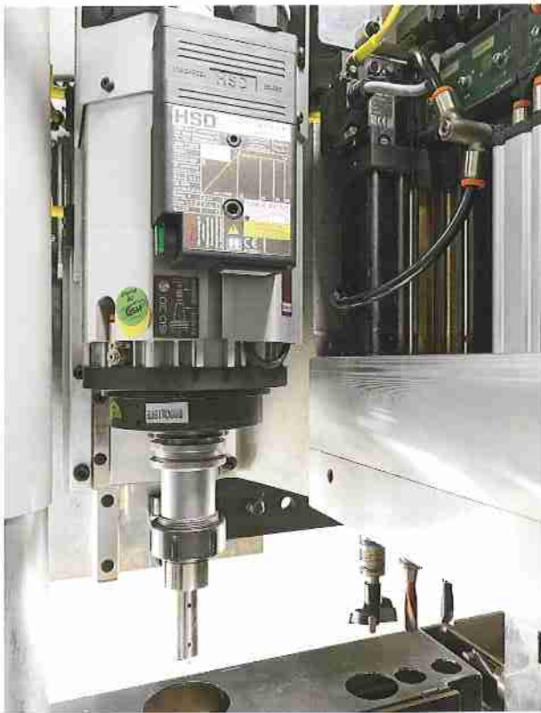
Elektrospindel mit ISO30 – Anschluß für eine schnelle und einfache Bestückung der Fräswerkzeuge.
