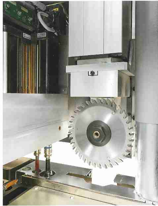
Leistungsfähiges Blatt (Durchm.160 mm) zum Fräsen entlang der X Achse.
