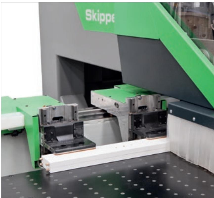
Skipper exécute facilement des façonnages « passants » sans risque d'abîmer les panneaux. Par ailleurs, elle façonne parfaitement les matériaux « transparents » et les pièces de très petites dimensions.
