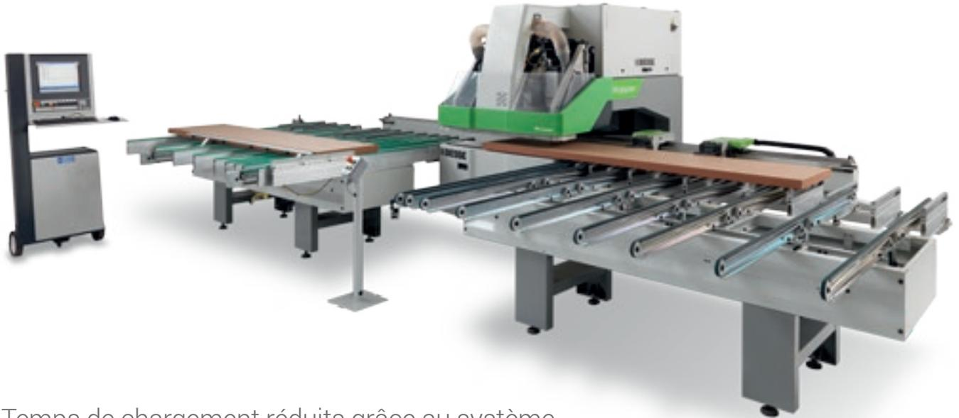
Temps de chargement réduits grâce au système automatique de positionnement des panneaux qui sont placés contre les butées de manière automatique.
