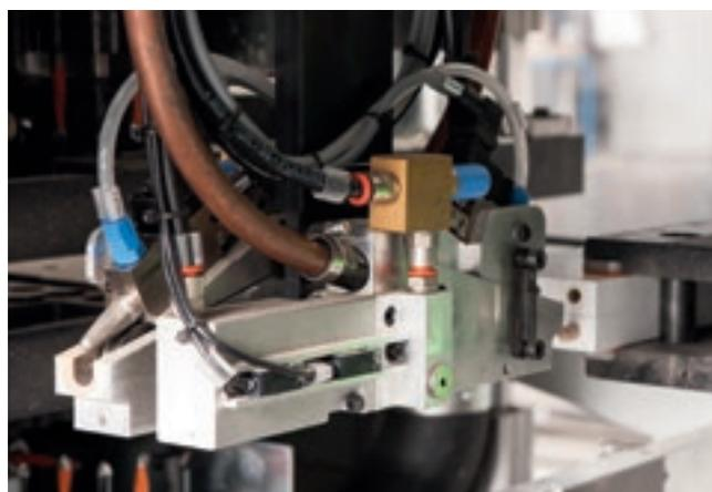
Système d'injection de la colle et d'insertion des tourillons avec deux groupes opposés pour le façonnage des deux extrémités du panneau.
