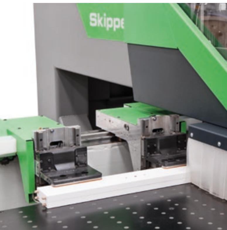
Zum Starten genügt es, das CNC-Programm aufzurufen; Man benötigt weder Werkzeuge oder Rüststellungen, noch eine Überprüfung der Spannzangen des Spannsystems mit automatischer Positionierung der Platten.
