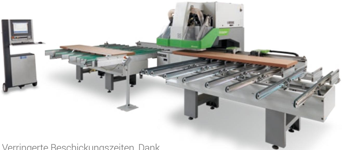
Verringerte Beschickungszeiten, Dank dem automatischen System für die Werkstückpositionierung durch welches die Platten automatisch zum Anschlagpunkt gebracht werden.
