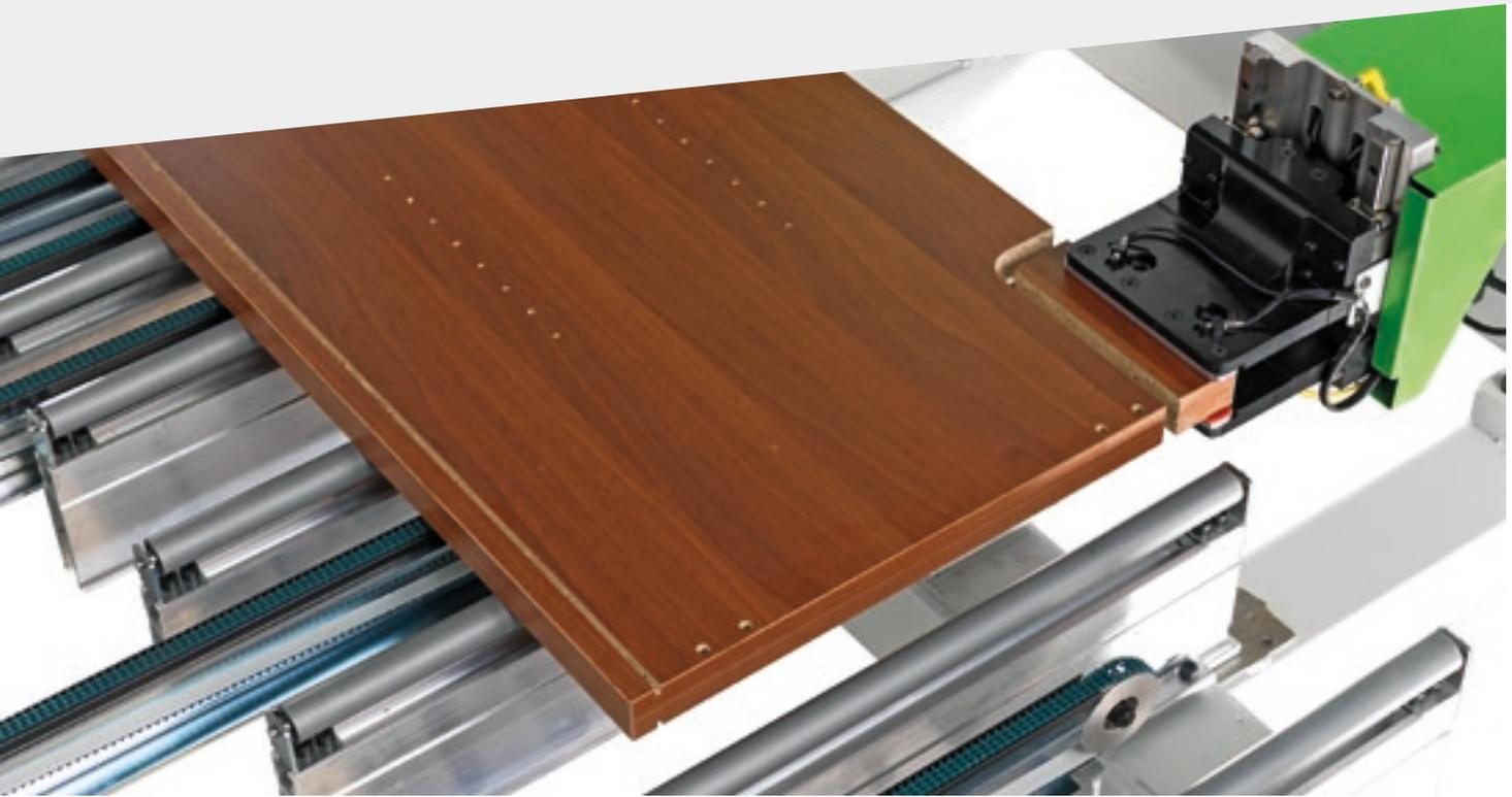
Totale Flexibilität für die Bearbeitung von Platten mit verschiedensten Abmessungen und Stärken. Bearbeitung ohne Unterbrechungen, gleichzeitig auf der Ober- und auf der Unterseite, ohne dass die Platten mehrmals durch die Maschine laufen müssen.
