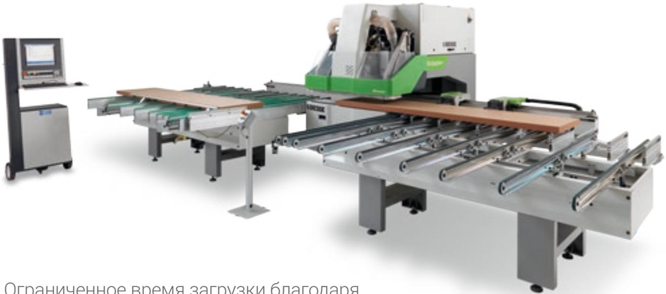
Ограниченное время загрузки благодаря автоматической системе позиционирования панелей, которые базируются по упорам в полностью автоматическом режиме.
