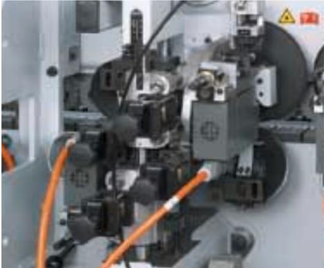
Schwenkbares Vorfräsaggregat mit pneumatischer Verstellung.
