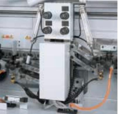
Formfräse mit automatischer Einstellung zwischen Dünn- und Dickkante.
