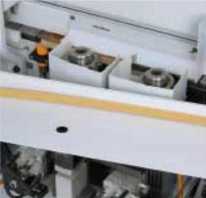
Fügefräsaggregat zum Nachfräsen gesägter Werkstückkanten zur Erzeugung einer optimalen Kantenqualität.
