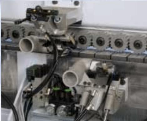
Profiliziehlingenaggregat mit Schnellwechsellköpfen für einfachen Werkzeugwechsel.
