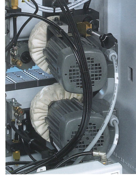
Schwabbelaggregat Zum Polieren von Kanten für natürliche Farbtreue.
