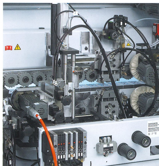
Formfräsaggregat (KDN 530 C - KDF 540 GC) Optimales Formfräsen ohne Einstellarbeiten durch Kopplung von DIA-Werkzeug und Tastrolle. Ausgerüstet mit automatischer Verstellung zwischen Dünn- und Dickkante (optional). Werkstückdicke 40 mm.
