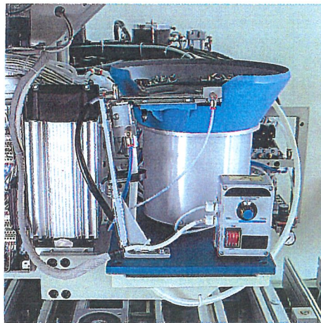
Gruppo vibratore-alimentatore per inserti filettati. Vibrating/feeding unit for threaded inserts. Vibrator-Speiser Aggregat für Gewindebuchsen. Groupe vibreur-alimentateur pour éléments filetés. Grupo vibrador-alimentador de roscas.
