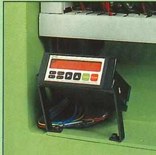
Computer-unterstützte Synchronisation des Schleifkissen-Einsatzes mit der stufenlosen Vorschubgeschwindigkeit.
