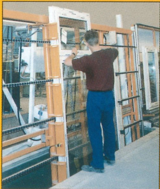
Anschlag-/Verglasungsstation unter Bodenniveau fahrend-ergonomisches Handling
