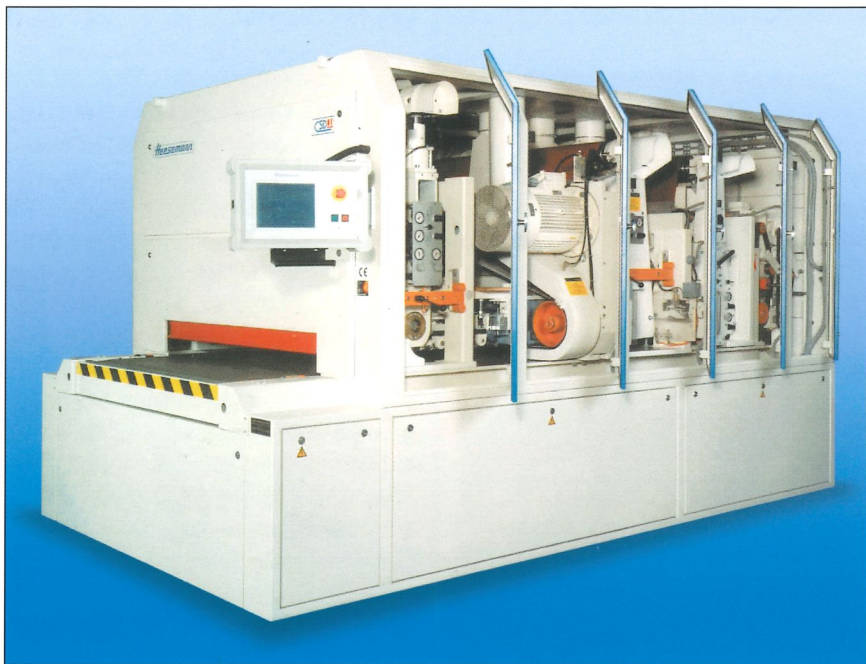
Kreuzschleifautomat für eine einwandfreie Flächenbildung bei quer- und längsfurnierten Teilen
