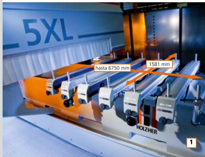
La estructura de la máquina de consolas y la potencia móvil tipo cuello de cisne, ambas de construcción mecanosoldada, garantizan una estabilidad superior. Combinada con correderas prismáticas invertidas y templadas, constituye la base para un funcionamiento preciso de los potentes agregados. El arrastre en los ejes X e Y se efectúa gracias a una cremallera y garantiza una precisión máxima para aceleraciones y velocidades elevadas.
