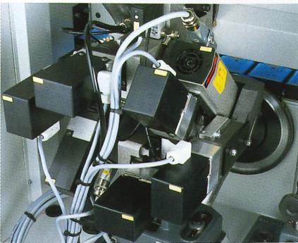
**Multifunktionsfräsaggregat 1824 MOT6**
