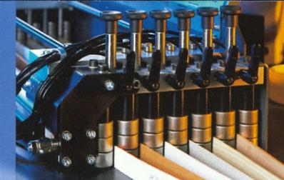
Schneller Wechsel zwischen verschiedenen Kantenarten oder reibungsloser Nachschub bei großen Serien: Mit der Mehrfachkantenzuführung 1805 sind bis zu 7 verschiedene Kanten auf Knopfdruck verfügbar.
