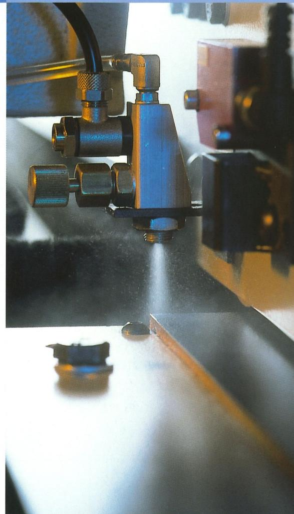
Doppelt einsetzbar für mehr Qualität – die **Sprüheinrichtung 1856** kann am Maschineneinlauf mit Antihafmittel eingesetzt werden und verhindert das Festsetzen von Kleber auf der Plattenoberfläche. Bei Verwendung im Auslaufbereich erleichtert Reinigungsmittel das Entfernen von Schmutz oder Kleberrückständen.
