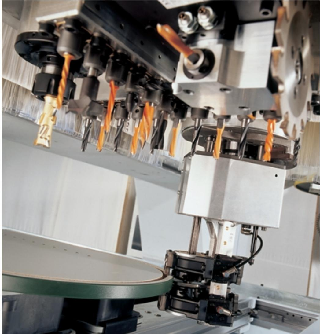
*Getastetes Kombi-Bündigfräs-Nachputzaggregat, benutzt Antrieb, C-Achse und Pneumatik*
