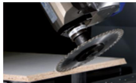
Coupes d'onglets précis et sans éclats et fraisage de rainures en biais pour un assemblage de panneaux
