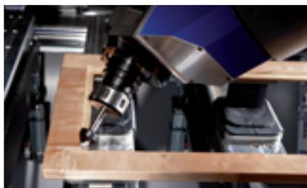
Usinage précis d'une feuilure pour l'insertion d'une vitre
