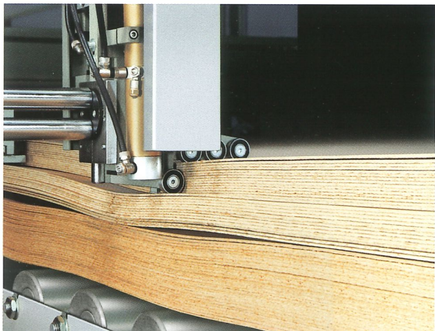
Mikroeinschub: Auch Paketeinschub für dünne Platten. Microinfeed: Book infeed of thin panels standard.
