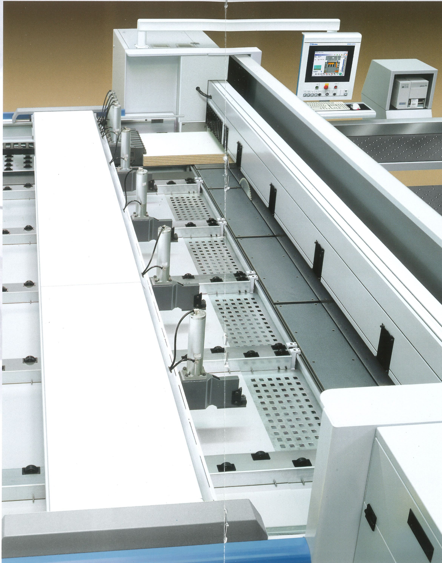
Variable Sägeblatt-Drehzahl – beste Schnittqualität für jedes Material. Variable rpm for main saw – perfect cutting quality for all kinds of panels.
