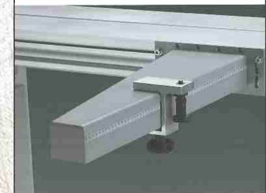
Pianetto per tagli paralleli alla lama. Tablette pour coupes parallèles à la lame. Small table for cuts parallel to blade. Mesa para cortes paralelos a la sierra. Столик для параллельных резов по отношению к пиле
