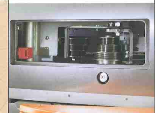
Cambio della velocità situato sul piano di lavoro. Changement de la vitesse situé sur la table d'usinage. Speed change on work table. Cambio de la velocidad colocado sobre el plano de trabajo. Устройство изменения скорости, расположенное на рабочем столе
