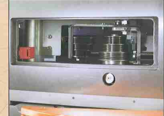
Cambio della velocità situato sul piano di lavoro. Changement de la vitesse situé sur la table d'usinage. Speed change on work table. Cambio de la velocidad colocado sobre el plano de trabajo. Устройство изменения скорости, расположенное на рабочем столе
