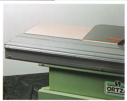
Verlängerungsplatte für das leichtere Schneiden langer Teile.
