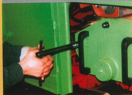
Démontage du contrepalier
