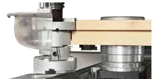
Gracias al **sistema TTS (Total Torque System)** exclusivo de SCM, el eje giratorio se bloquea de manera mecánica durante los trabajos que se realizan con una herramienta vertical para aumentar la rigidez del sistema.
