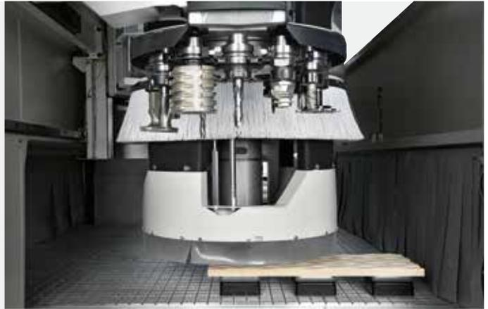
Durante el fresado con herramienta vertical, es accionada la **campana interna** que, gracias a sus dimensiones reducidas, resulta más eficaz para este tipo de trabajo.
