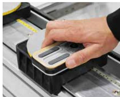
Gracias al enganche rápido y al **sistema de transmisión del vacío "tubeless"**, es posible configurar libremente la mesa de trabajo en función de las geometrías de las piezas que se han de trabajar.
