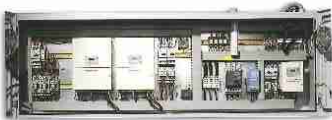
○ electronic inverters for varying belt speed inverters électroniques pour variation vitesse bandes Elektronische Umschalter für die Änderung der Bandgeschwindigkeit
