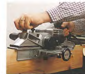
Mikrometeranschlag für die Erzeugung von Fasen mit verschiedenen Winkeln.
