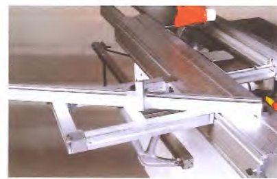
Präzisionsführungen aus eloxiertem Aluminiumprofilen
