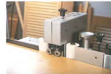
Trimmstation: Schneidet das Band an beiden Seiten gleichzeitig bündig.
