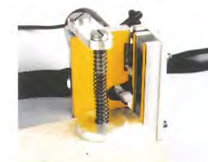
Ecken kappen: Spannplatte mit Feder
