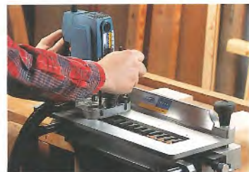
Dübelstart von beiden Seiten einstellbar. Perfekte Zinkenverbindungen.
