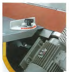
Stufenlos schwenkbares Schleifaggregat von 0° - 90°
