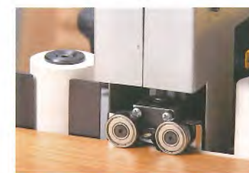
Trimmstation: Schneidet das Band an beiden Seiten bündig.
