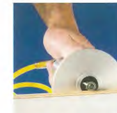
Materialschonendes Arbeiten mit Spezialführungsteller
