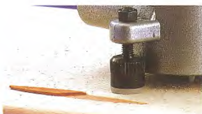
Der Umleimer Fräsvorsatz (Extra-Zubehör) ermöglicht ein stirnseitiges Bündigfräsen von Massivholz-umleimern, sowie von Holzflücken. Mit seiner großen Auflagefläche und dem Handknopf bietet er eine perfekte Stabilität.
