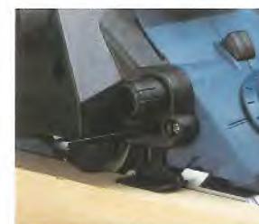
Justierbarer, seitlicher Schuh für das Falzen bis 25mm
