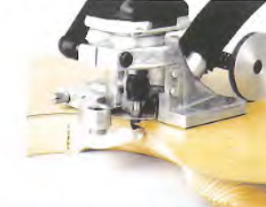
Fräsen von Bögen und geschweiften Werkstücken mit Rundbogenanschlag (Zubehör)
