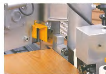
Kantenbeschneiden sowohl am vorderen als auch am hinteren Ende des Bandes.
