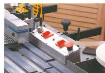
Sicherheitskontrolle (STOP) Elektronische Temperaturkontrolle.
