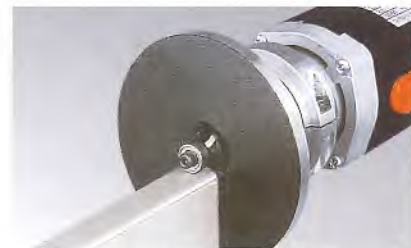
Ecken und Kanten bei PVC-Umleimern, z.B. Raukantex
