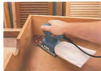
Beim Verwenden der Basis mit dem Delta-Aufsatz, können innere Ecken problemlos und schnell geschliffen werden.
