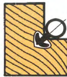
Mit Aufnahmezapfen; für ein einfaches Einbohren zu Beginn des Nutvorganges.
