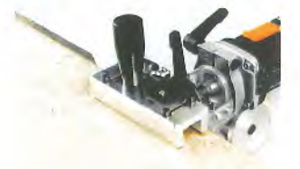
Abfräsen von überstehendem Holz und Kunststoffurnieren.
