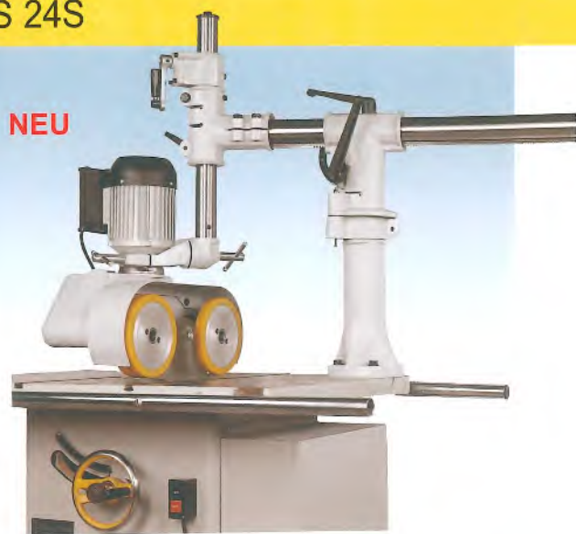
Rückschlagsicherung Standard Vorschubapparat
