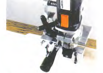
Abfräsen mit sicherer Führung durch rechtwinkligen Anschlag
