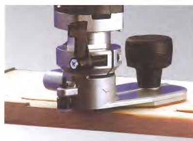
Der Umleimer Fräsvorsatz (Extra-Zubehör) ermöglicht ein stirnseitiges Bündigfräsen von Massivholz-umleimern, sowie von Holzflücken. Mit seiner großen Auflagefläche und dem Handknopf bietet er eine perfekte Stabilität.
