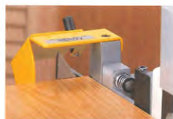
Kappaggregat: Bündigschneiden der überstehenden Kante vorne und hinten
