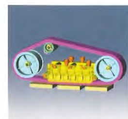
Gehärtete Stahlrollen gewähren eine präzise Führung
