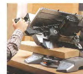
Die Maschine besitzt eine große Werkstückauflagefläche. Einfache Winkelverstellung mit Arretierungszapfen.
