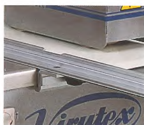
Die CO49K ist mit einem beweglichen Anschlag und einer Skala ausgerüstet.
