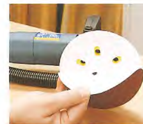
Staubabsaug-Bohrungen zum Anbringen der Standard-Schleifscheiben.
