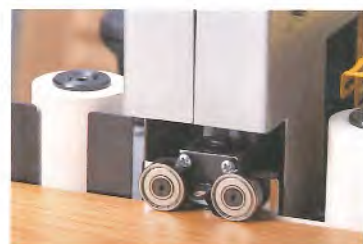
Trimmstation: Beidseitiges bündigschneiden beider Kanten.
