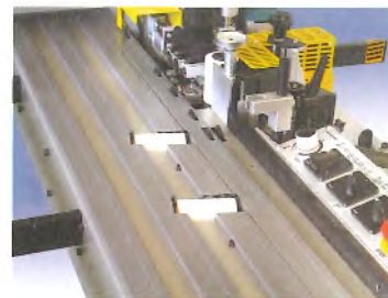
Als Ergänzung der Beschickungsvorrichtung hat die neue EB35 zwei zusätzliche Rollen im Anleimtisch, damit der Anpressdruck besonders bei 3 Millimeter starken Kanten optimal ist.
