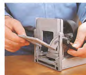
Winkel und Höhe des vorderen Teiles können beliebig eingestellt werden.
