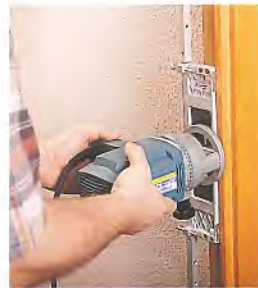
Anpassen von Scharnieren mit dem CPN66-Kopf.
