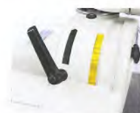
Verstellhebel für Radienmindest- durchmesser 300mm
