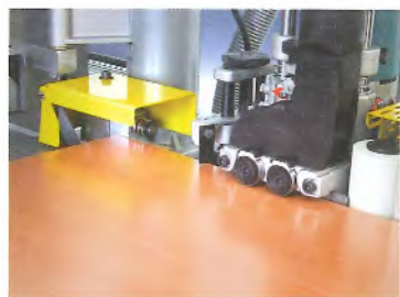
Abschrägaggregat: Bündigkappen der überstehenden Kante vorne und hinten mit Radius oder 10° Fase (bis zu 2 mm starke Kanten)
