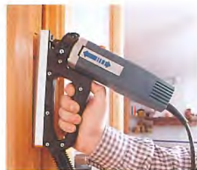
Mit Aufnahmezapfen; für ein einfaches Einbohren zu Beginn des Nutvorganges.
