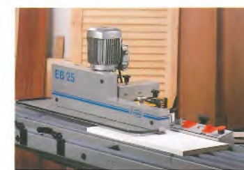
Vorschubeinheit: Zuführung des zu bearbeitenden Werkstückes.
