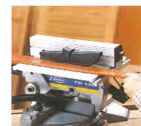
Oberer Tisch mit Führung und Spaltmesser. Ideal für Stückarbeiten und Einstellungen. Sicherer Schutz vor dem Sägeblatt.
