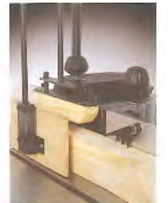
Einsatz mit Druckhölzern
