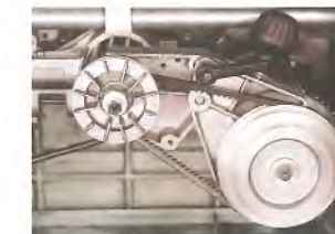
Geschwindigkeitsverstellung durch Umlegen des Keilriemens auf den Stufenscheiben
