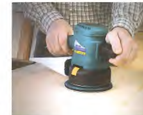
RTE 146L für Feinschliff (Hub 4mm) RTE 46L für Grobschliff (Hub 7mm)
