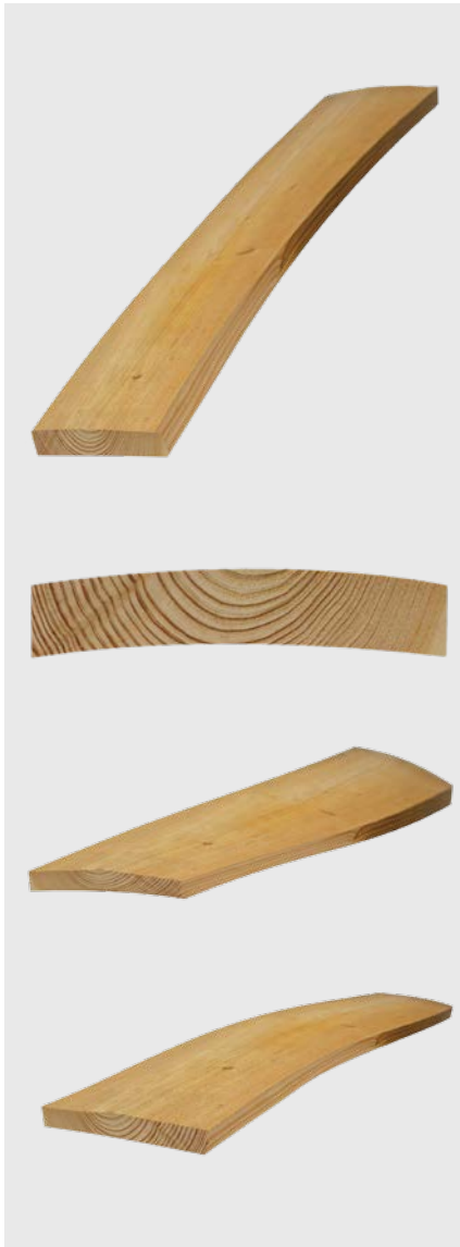
Bloques con alabeos longitudinales o transversales, deformaciones o curvaturas
