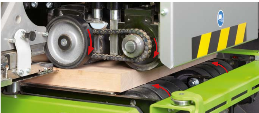
Rodillos de transporte accionados arriba y abajo
