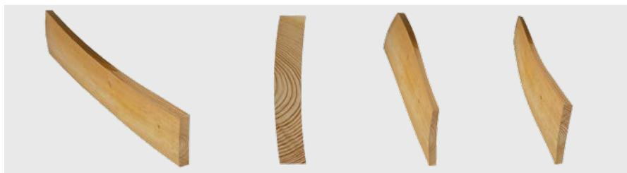
Blocchi con falcatura longitudinale o trasversale, curvatura o svergolamento
