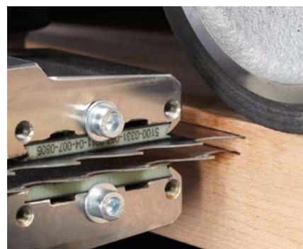
Guida in carbonio "high-tech" estremamente resistente all'abrasione
