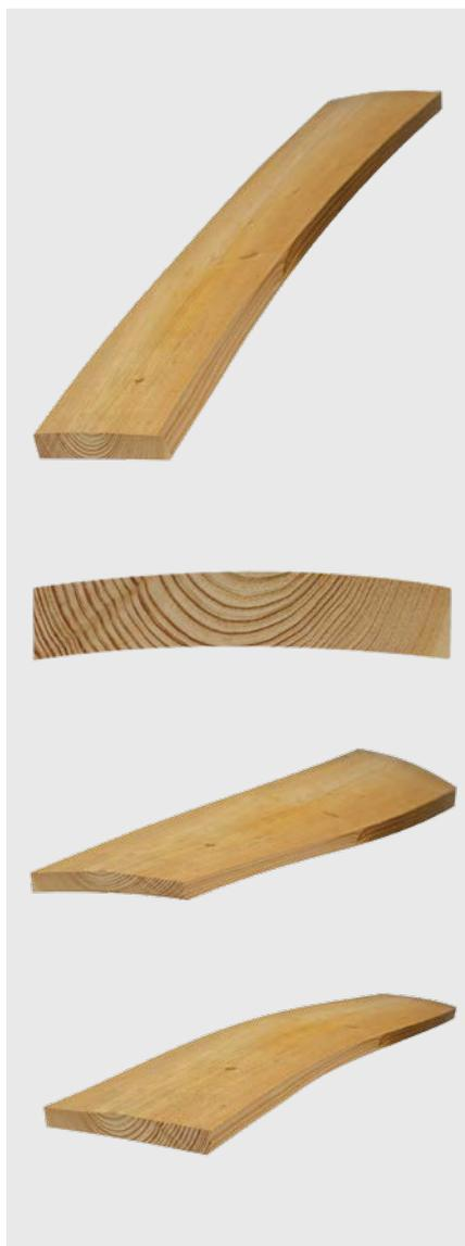
Blocchi con falcatura longitudinale o trasversale, curvatura o svergolamento
