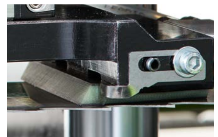
Guide lame à pression au carbone extrêmement résistant à l'usure
