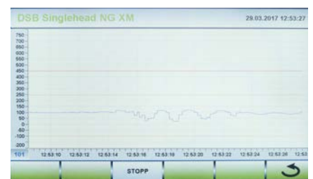
Surveillance du sciage contrôlée par des capteurs
