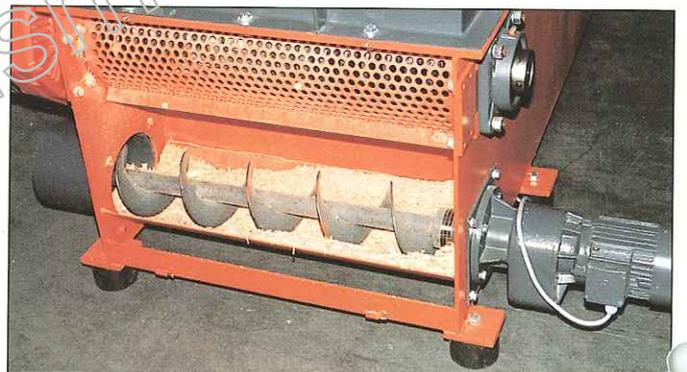
**Zubehör:** Bei schwächeren Absaugungen kann das Schnittgut mit einer Schnecke direkt dem Ventilator kontinuierlich zugeführt werden (Mehrpreis).
