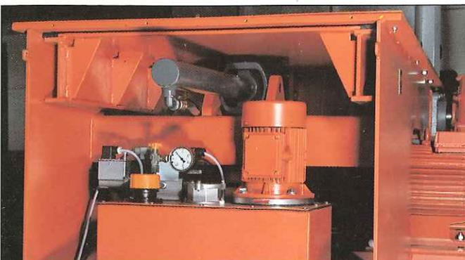
**Hydraulikaggregat mit Ventilblock.** Druckschalter, Antriebsmotor, platzsparend und geschützt unterhalb der Maschine.
