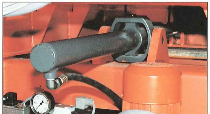
Hydraulikzylinder »kardanisch« aufgehängt, um Querkräfte auf die Kolbenmanschetten zu vermeiden.
