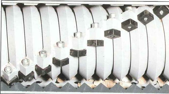
Profilrotor mit Wende-Brechplatten. Hohe Standzeit durch Verwendung von Spezial-Stahl. Enorme Zerspanung beim Brech- und Quetschvorgang durch horizontale Bewegung der Werkzeuge. **Ziehender Schnitt – geringer Kraftaufwand.**
