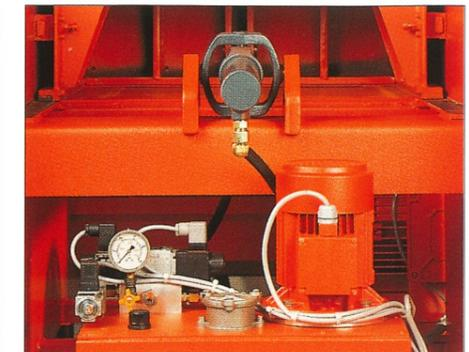
Hydraulikzylinder "kardanisch" aufgehängt, um Querkräfte auf die Kolbenmanschetten zu vermeiden.
