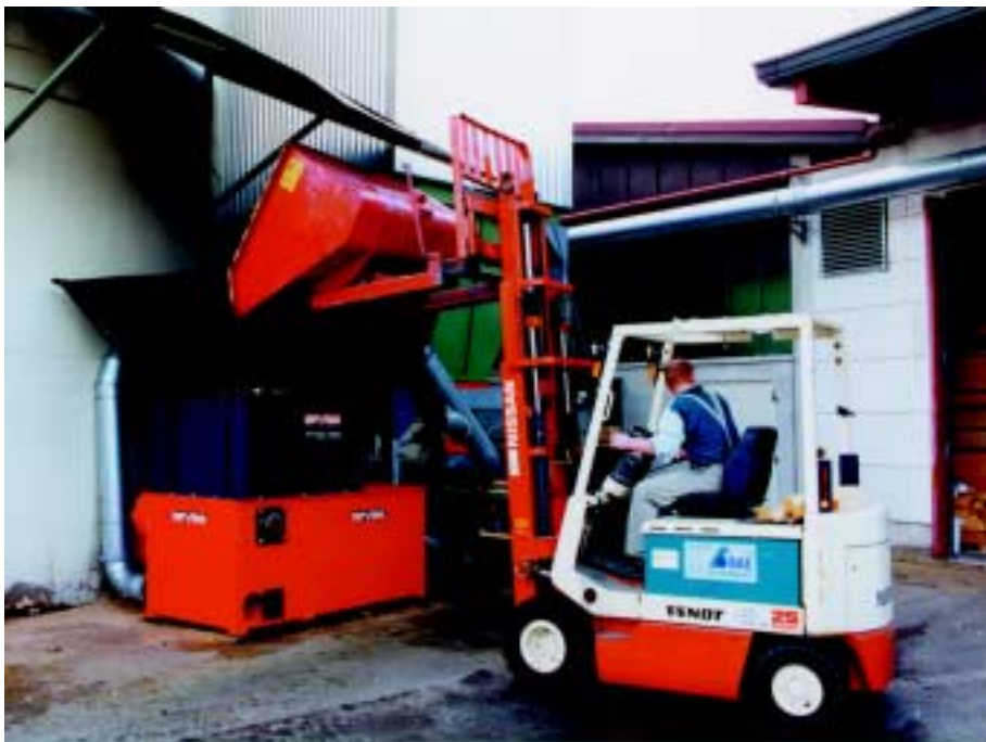
Zerkleinerer der Baureihe WL 6S, Materialaufgabe mittels eines Gabelstaplers mit Abkippvorrichtung
