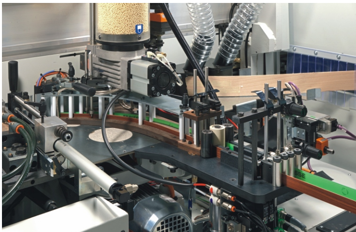
Automatic edge changeover, managed by PC-Flat (opt). 封边材料全自动更换系统，由PC机管理（选配）
