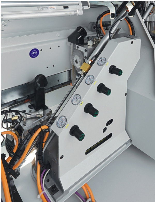
End trimming unit IN-801. 前后修边装置 IN-801
