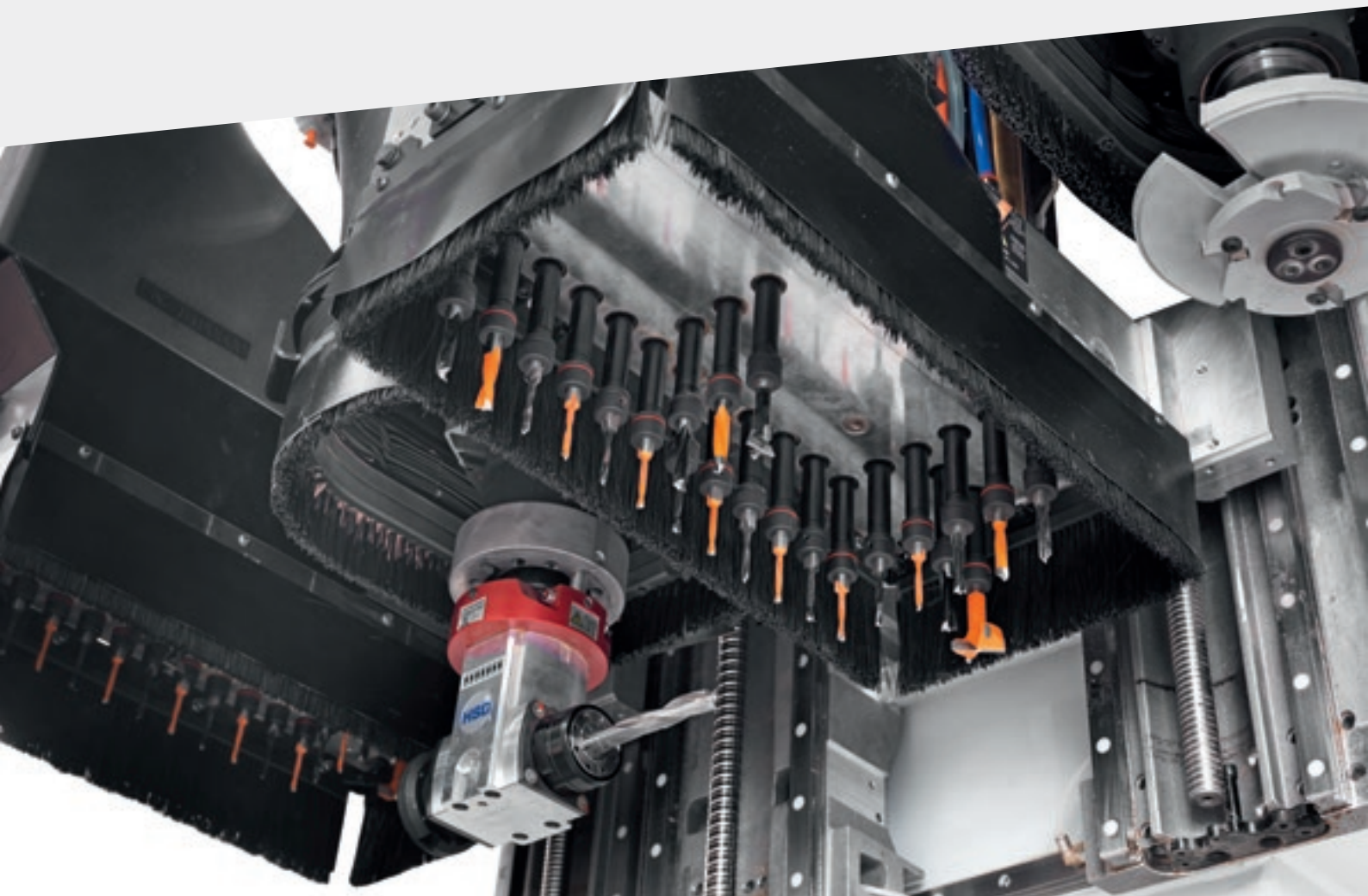
Tête à percer BHZ 22 pour une capacité de perçage maximale en nesting en double configuration et une productivité optimale dans sa catégorie.
