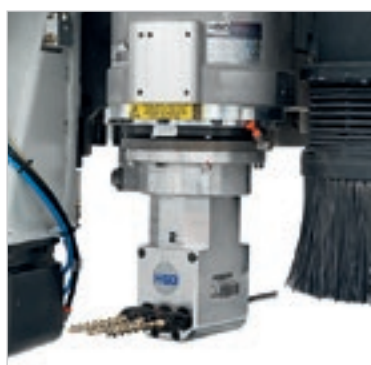
O grupo multifuncional , com posicionamento contínuo em 360° controlado por CN, pode receber agregados para a execução de usinagens específicas (fenda para ferragens, alojamento para dobradiças, perfuração horizontal profunda, usinagem de topo, etc.).
