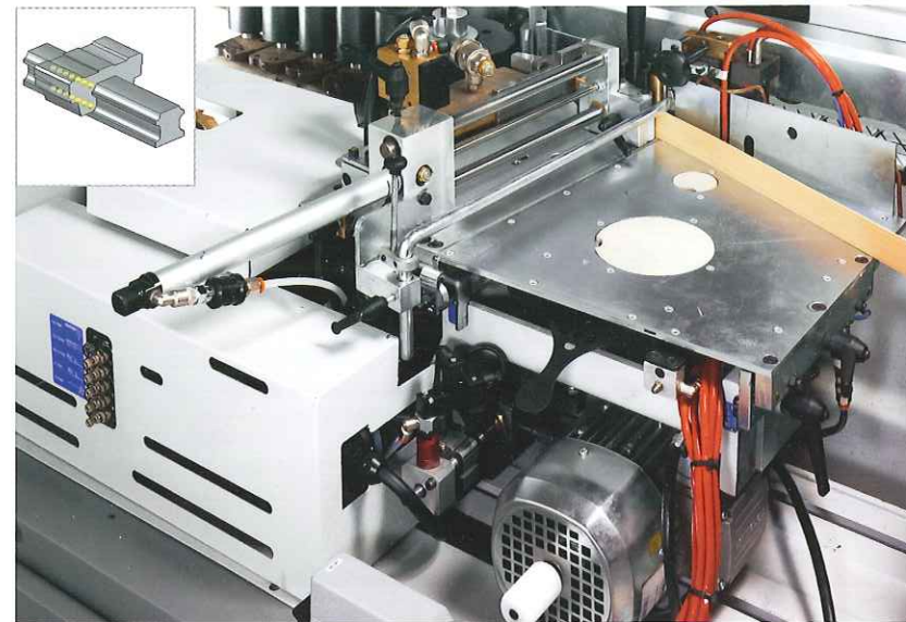
Gluing unit VC-710. Groupe d'encollage VC-710. Aggregat zum Anleimen VC-710.
