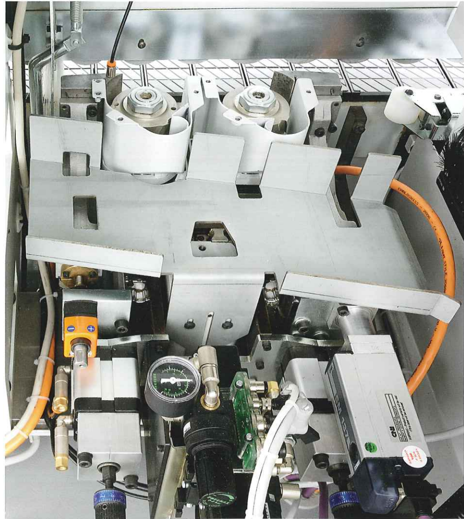
Pre-milling unit FI-502. Groupe meleur FI-502. Fugefräsaggregat FI-502.
