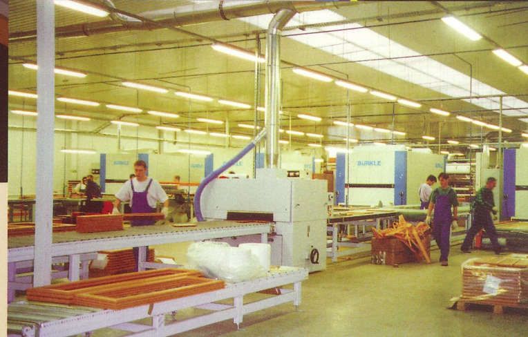
BTF Zirkulation mit anschließender Besäumung der Folienüberstände und Reinigung der Rückseite BTF circulation with integrated trimming and cleaning
