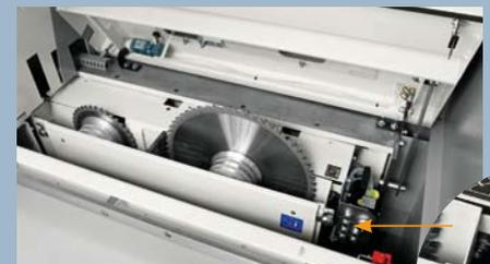
Freigabe der pneumatischen Flansche mittels Wahlschalter
