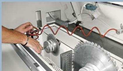
Pneumatische Verriegelung der Haupt- und Vorritzsägeblatflansche
