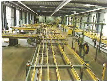
Autom. Fördersysteme in einer Fensterfertigung.
