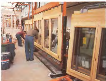
Montagelinie in einer Holzfenster -Fertigung.
