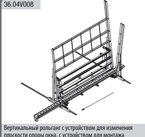
36.04V008 Вертикальный рольганг с устройством для изменения плоскости опоры окна, с устройством для монтажа рольставен или без него
